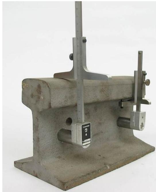
Abbildung 22: Überprüfung der Bohrabstände mit SBKL oder SAHL 1
